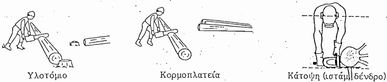
Σχήμα 7.5: Τεμαχισμός και αποικλάδωση με αλυσοπρίονο
